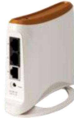
RAP-3, con una velocidad de datos de hasta 300 Mbps, tiene tres puertos Ethernet 10/100BASE-T y un puerto USB para conexión a redes 3G y 4G. También está disponible con un puerto de alimentación por Ethernet (PoE) 802.3af para teléfonos IP y otros dispositivos.
