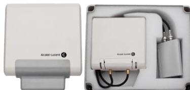
Los puntos de acceso 4080 IP DECT pueden montarse en la pared y en el techo y están disponibles con dos referencias, una para la versión con antena interna y otra para conectar una antena de ganancia externa mediante conectores SMA. Consulte el catálogo y la información técnica para obtener la lista de antenas compatibles. Se puede utilizar carcasa dedicada para instalar el punto de acceso 4080 IP DECT en el exterior.
